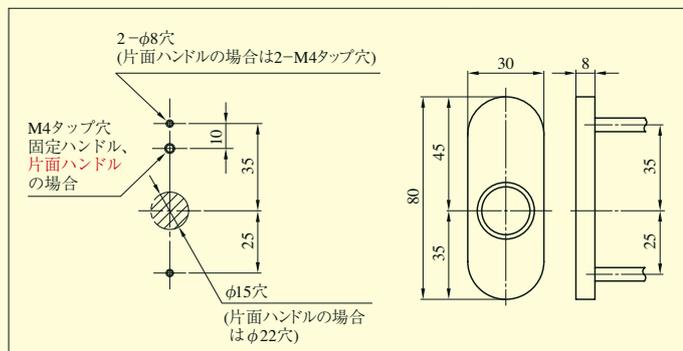
(注6) バックセット31mm以外で小判座を取り付ける場合は、扉へ直止めとなるため、最小扉厚は29mmとなります。取付の際にはφ8穴をM3タップ穴にて、取付ねじはM3をご使用ください。木扉の場合は、ねじ用穴加工は不要です。
